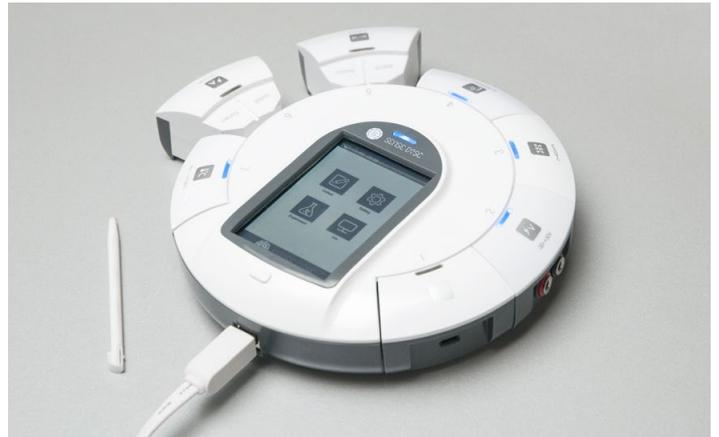
SenseDisc è un datalogger per l'acquisizione ed analisi dati di forma compatta e facile da maneggiare. Esso consente di collegare molteplici sensori essendo estremamente modulare. Il sistema innovativo ad incastro dei sensori risolve e definitivamente il problema dei cavi. È possibile utilizzarlo collegato ad un PC oppure in modalità Stand Alone avendo a disposizione un display touch screen sufficientemente largo e chiaramente leggibile. È disponibile in 3 versioni:
